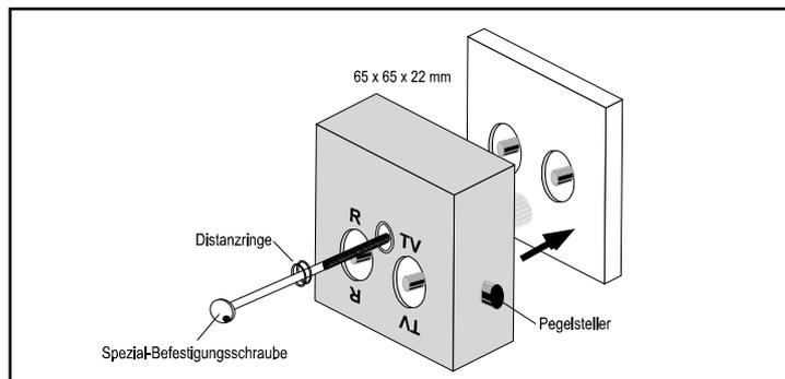
Der Polytron Sperrausatz besteht aus einem abgeschirmten inneren Sperrausatz (Metalldruckgußgehäuse), der Kunststoffabdeckung, einer Spezial-Befestigungsschraube mit zwei Distanzringen und einer weißen Abdeckscheibe. Der Sperrausatz paßt auf jede handelsübliche Antennensteckdose nach DIN 45330.
